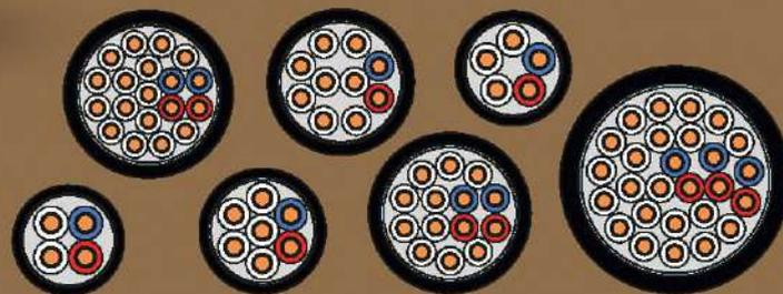
Сердечник кабеля представляет собой скрученные жилы, каждая из которых покрыта слоем огнестойкой изоляции (термическим барьером), выполненным из двух слоюдосодержащих лент, наложенных с перекрытием, и изолирована полимерной композицией, не содержащей
