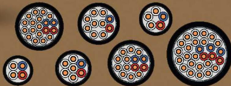
Сердечник кабеля представляет собой скрученные жилы, каждая из которых покрыта слоем огнестойкой изоляции (термическим барьером), выполненным из двух слюдосодержащих лент и изолирована сверху поливинилхлоридным пластикатом. Поверх, скрученных
