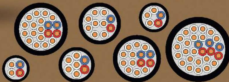
Сердечник кабеля представляет собой скрученные жилы, каждая из которых покрыта слоем огнестойкой изоляции (термическим барьером), выполненным из двух слюдосодержащих лент, наложенных с перекрытием, и изолирована полимерной композицией, не содержащей
