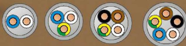
Наличие в конструкции изделия желто-зеленой жилы заземления обозначается в маркировке символом «J», а отсутствие - символом «O» соответственно
